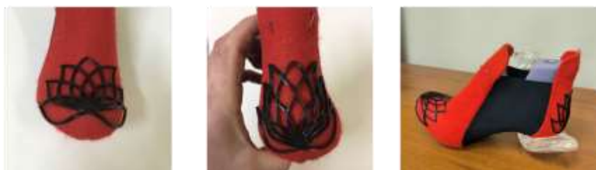
Рис. 8. Опытные образцы заготовки верха обуви из войлока с 3D-детальями с функциями жесткого подноски и задника
